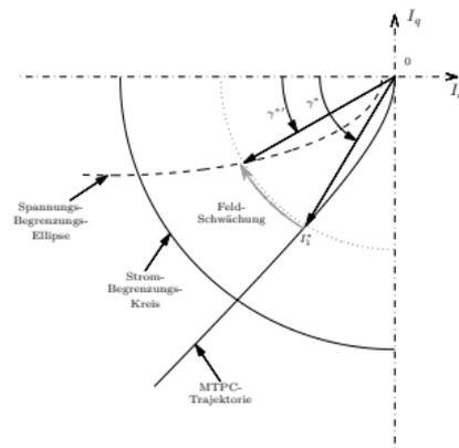
Abb. 6.101 Wirkungsweise der Feldschwächregelung mit Spannungsrückkopplung
